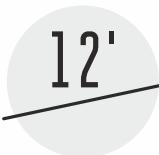
**1.3** Предпочтительный уклон кровли из черепицы RoofShield — не менее 20% (12'). Под черепицей по всей поверхности предусматривают подкладочный слой из рулонного материала, служащий дополнительной водоизоляцией.
