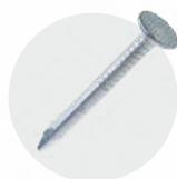
**2.3.2** Для механической фиксации гибкой черепицы к основанию применяют оцинкованные кровельные гвозди с увеличенной шляпкой диаметром не менее 8 мм. Расход гвоздей 70–100 г/м<sup>2</sup>
